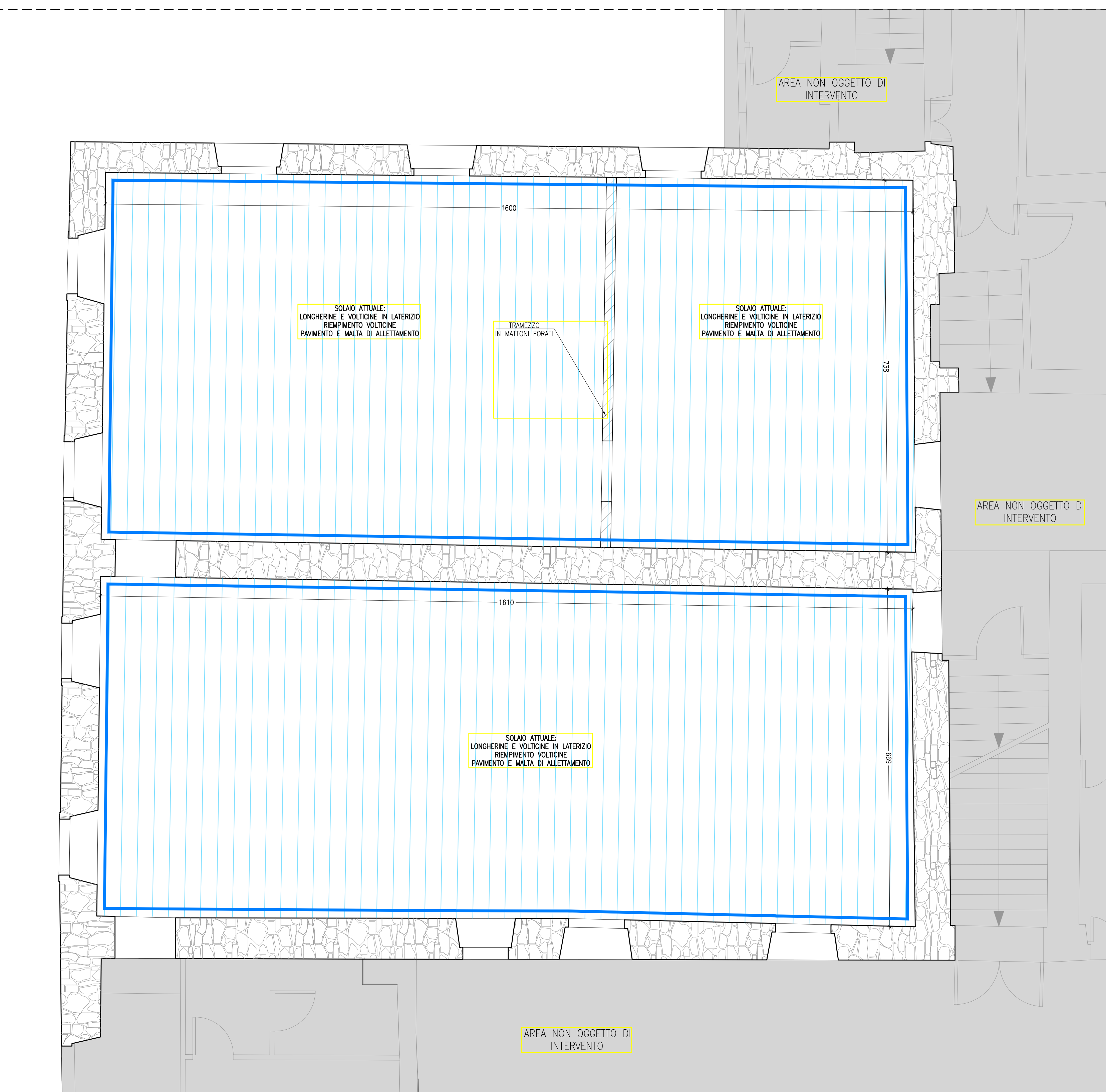
PIANTA DEL SOLAIO CALPESTIO DI PIANO PRIMO: STATO ATTUALE SCALA 1:50
